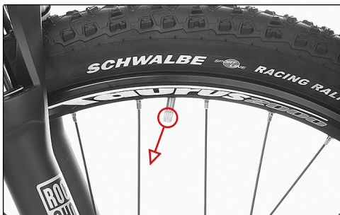
Ventil zeigt nicht zum Laufradmittelpunkt
